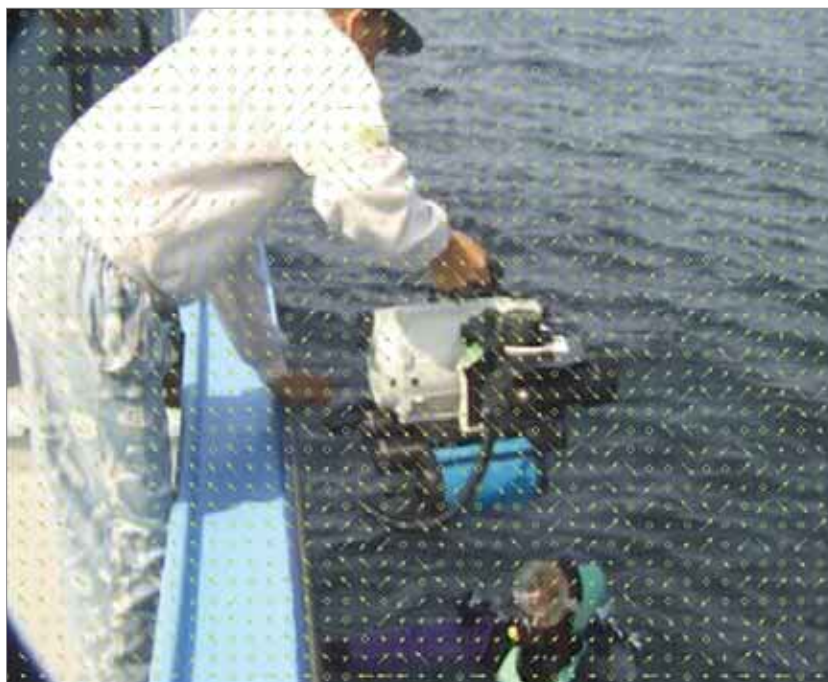
Bild 5: Darstellung der Bewegungsvektoren prädizierter Bilder (B, P) als Einblendung in das decodierte Bild
